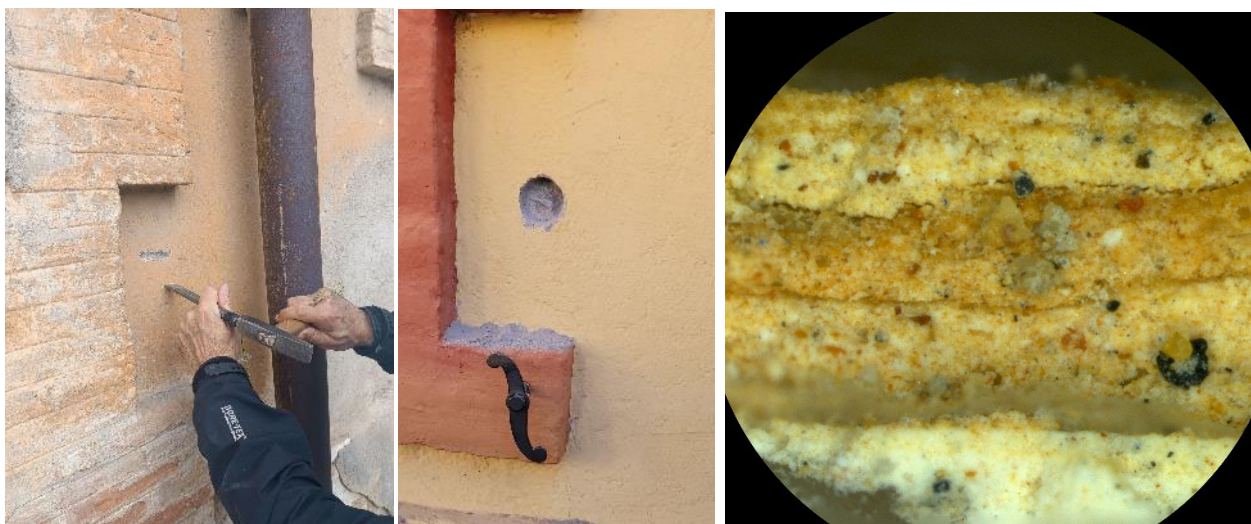
Extracció de mostres dels paraments i la seva estratigrafia de ocre vista a 80 augments.
